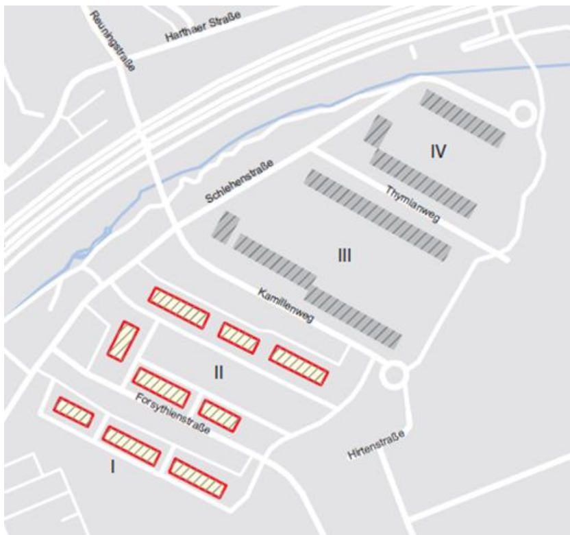
Abbildung 9.2-6: Die Karte zeigt die bauliche Struktur des Quartiers Kräutersiedlung. In den ersten beiden Bauabschnitten wurden durch vertikalen Rückbau von Hauseingängen die langen Baukörper getrennt und zusätzlich in der Höhe reduziert durch Rückbau der oberen zwei bis drei Geschosse. Die verbleibenden Wohnungen in den unteren Geschossen wurden aufwändig umgebaut und modernisiert. Die geplante Umsetzung des gleichen Konzeptes bei den Bauabschnitten drei und vier scheiterte daran, dass einerseits die Förderung nicht mehr zur Verfügung stand, und dass andererseits die erforderliche Liquidität im Unternehmen fehlte. So wurden die dort vorhandenen Gebäude ersatzlos abgerissen. Quelle: Eigene Karte und Datengrundlage.
